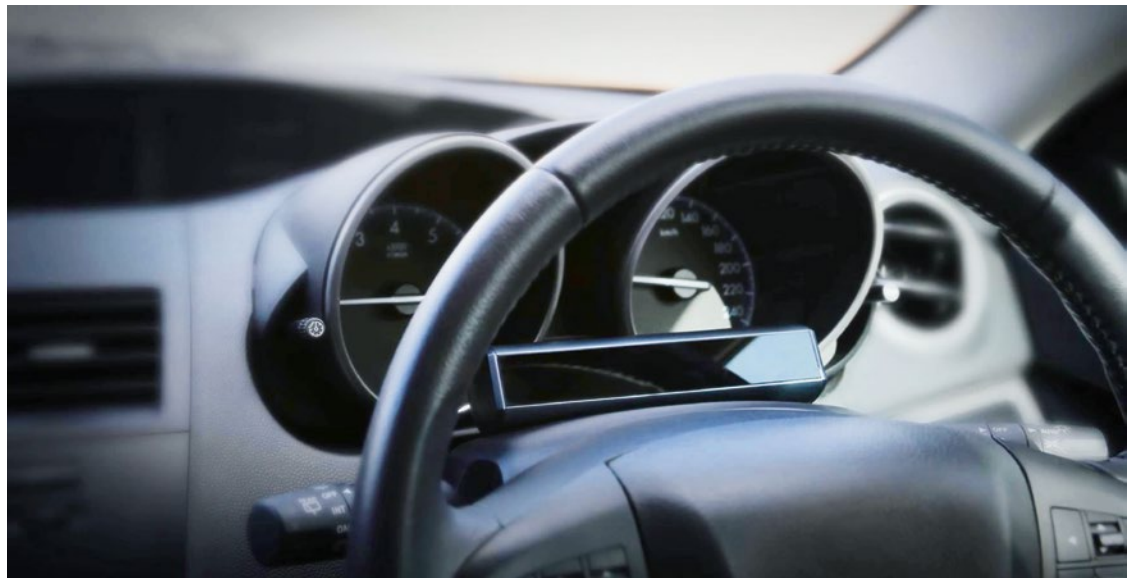
BILD 1 Das Pupil-Based-Driver-Monitoring-System ist nur eine kleine, nicht störende Kamera; diese ist momentan in der Nähe des Lenkrads am Armaturenbrett befestigt, um die Augen des Fahrers im Blick zu haben (© Harman)
