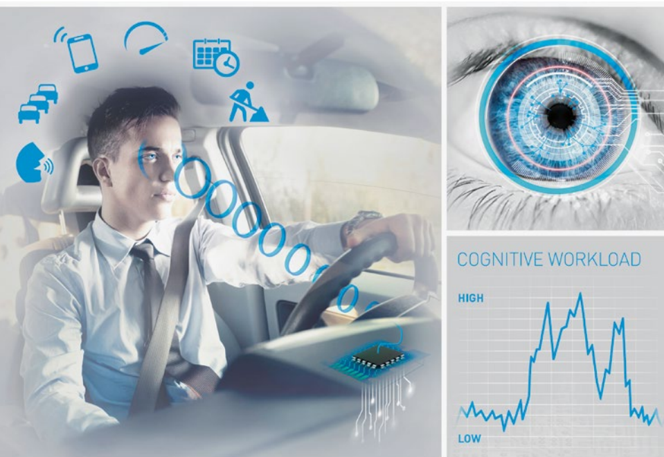
BILD 2 Der einzige Fokus sind die Pupillen des Fahrers; die einzigen, wenn auch sehr wichtigen und komplex berechneten Daten ergeben einen Wert zwischen 0 und 1 (© Harman)
