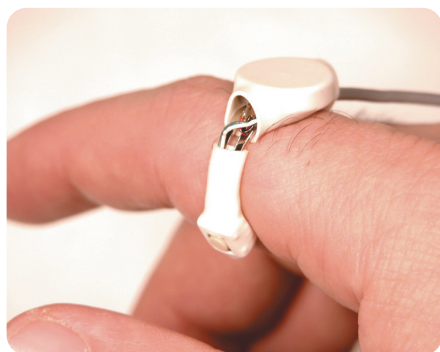
▲ Prototip prstena kojim lokalni sugovornici mogu anonimno i nenametljivo izglasati veto javljanju na dolazeći telefonski poziv
